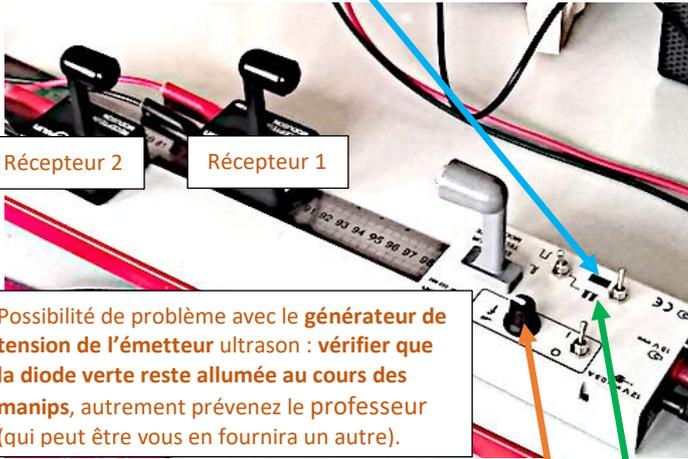
Possibilité de problème avec le **générateur de tension de l'émetteur ultrason** : vérifier que la diode verte reste allumée au cours des manip, autrement prévenez le professeur (qui peut être vous en fournira un autre).
